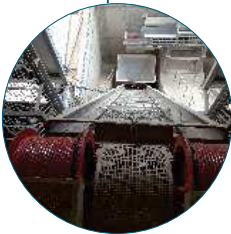
Skip hoist: bottom discharge / tilting Skip: trappe de vidange ou à reversement
